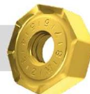
Una nuova fresa per spianatura altamente performante che utilizza due tipi di inserti bilaterali negativi. Inserti ottagonali performanti ON..06 con 16 taglienti e APMX di 4 mm, e inserti produttivi SN.. 17 con 8 taglienti e APMX fino a 7 mm. Corpo fresa a manicotto (DC = 50 - 250 mm) disponibile con passo differenziato dei denti. Corpo trattato per una maggiore durata dell'utensile.
